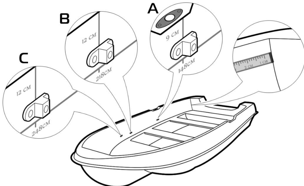
1. Установите кронштейны крепления дуг к корпусу лодки, на расстоянии
